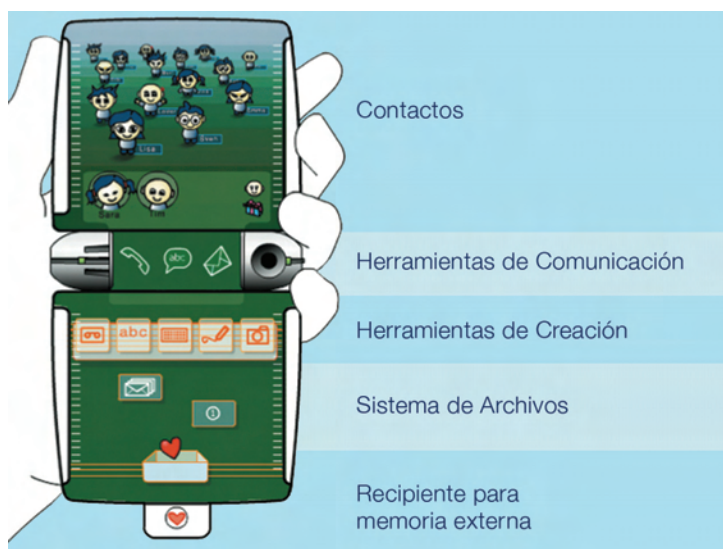
Figura 6. Vista general del concepto de diseño de teléfono móvil propuesto por Berg et al. , 2003.
